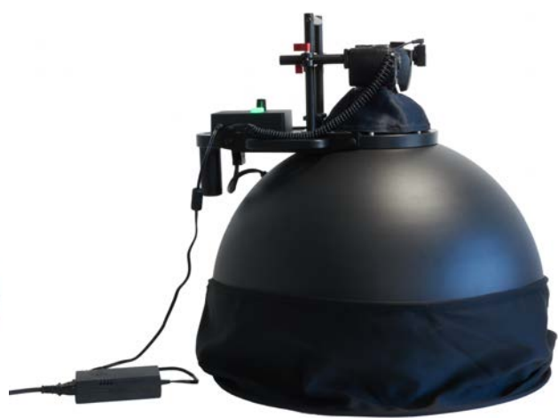
Abbildung 10: Aufgebauter Beleuchtungsdom mit Lichtschutzmäntel
