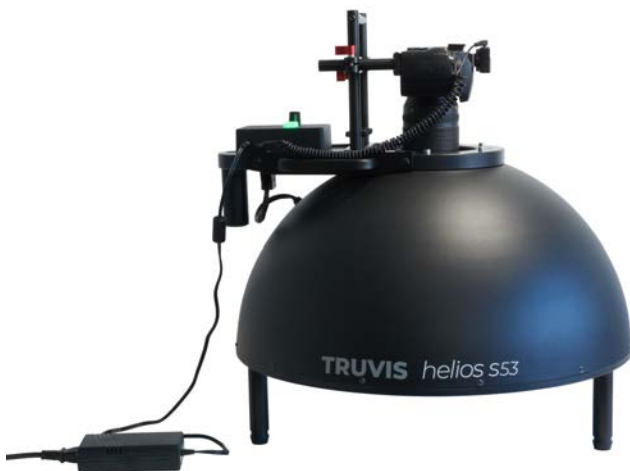
Abbildung 9: Aufgebauter Beleuchtungsdom ohne Lichtschutzmäntel
